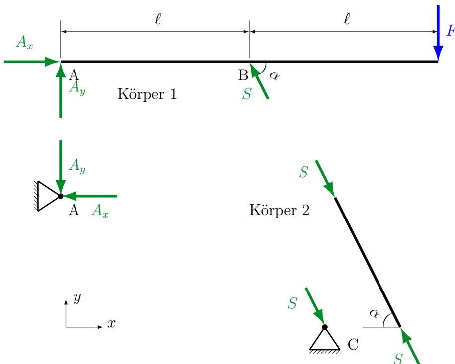
Wiederholung: Pendelstützen sind beidseitig gelenkig gelagerte Stäbe, die selbst unbelastet sind. Sie werden freigeschnitten und durch Kräfte in Stablängsrichtung ersetzt. Am Stab selbst wirken beidseitig entweder Druckkräfte, wie hier oder beidseitig Zugkräfte. Zur Verdeutlichung des Newtonschen Gegenwirkungsprinzips werden hier die abgeschnittenen Lager dargestellt. Sie können gerne weggelassen werden.
