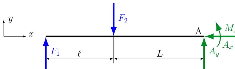
Um die Momentendarstellung von der einen in die andere Darstellungsform zu überführen benötigen wir die rechte Hand. Der Daumen zeigt in die Richtung des Doppelpfeils. Hier ist das die  $z$ -Richtung, aus der Zeichenebene heraus. Die gekrümmten Finger der rechten Hand zeigen die Wirkrichtung des gekrümmten Pfeils, der vereinfacht das Moment in einer ebenen Skizze darstellt.
