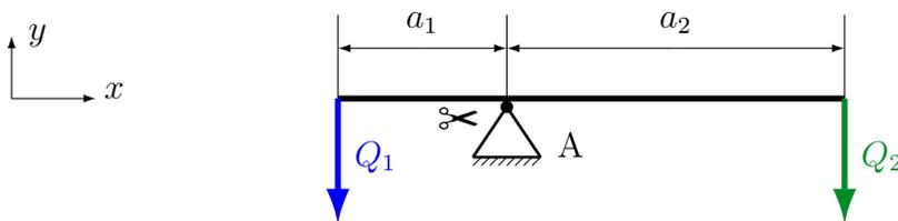
Wir schneiden das Lager ab ✂ und ersetzen es durch Lagerreaktionen, hier: zweiwertiges Lager.
