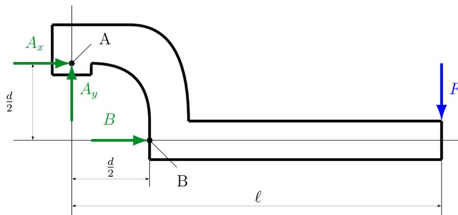
Auch hier muss die Wertigkeit der Lagerungs- oder Berührstellen selbst gefunden werden. Beim Punkt B fehlt der Hinweis auf Schmierstoff, wie beim Eisenbahwagen, trotzdem sind die Verhältnisse auch hier mit einem einwertigen Lager vergleichbar.
