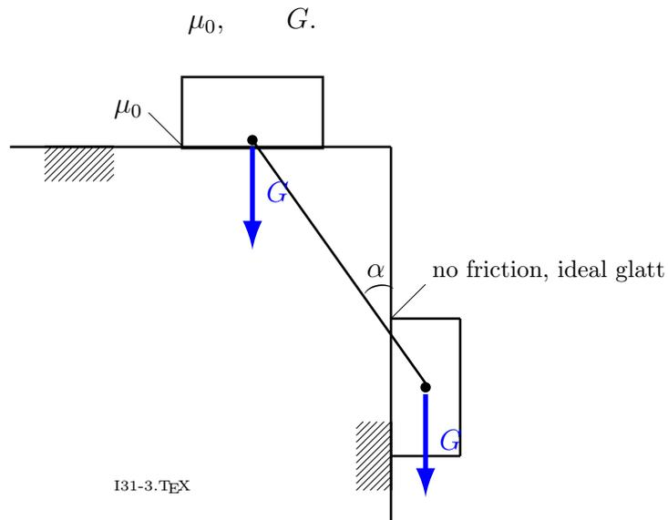
Wir müssen erkennen, wie sich das System bewegt, wenn die Haftreibungsgrenze überschritten wird. Es ist unmöglich, dass der Körper von alleine an der senkrechten Wand hochgehoben wird. Der Körper, der obenauf liegt, wird zur Tischkante nach rechts gleiten, die Haftreibungskraft verhindert das, wenn sie am Körper nach links zeigt.
