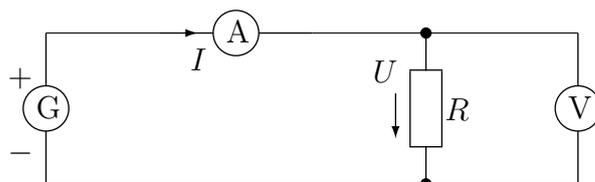
Wir sehen, der Strom fließt außerhalb der Spannungsquelle vom Plus- zum Minuspol. Dargestellt wird dies durch einen Pfeil auf der Leitung mit der Angabe  $I$ . Spannungen werden hingegen durch einen Pfeil neben einem Bauelement (hier  $R$ ) angegeben. Das Formelzeichen für die Spannung lautet  $U$ . Bei einem Verbraucher zeigt der Spannungspfeil in Stromrichtung.
