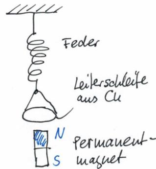
Wir haben ein schwingungsfähiges System aus einer Feder und einer Masse. Ein massiver Kupferring, eine Leiterschleife, bildet diese Masse. Wir lenken die Masse nach unten aus und lassen los. Der Kupferring wird auf- und abspringen. Da das ganze reibungsarm ist, wird das System mehrere Minuten lang schwingen. Man sagt, die Schwingung klingt langsam ab. Das ist der Normalfall.
