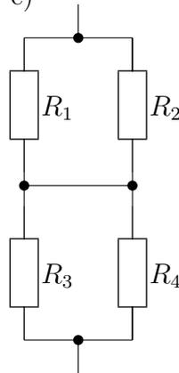
$$R_{\text{ges}} = (R_1 \parallel R_2) + (R_3 \parallel R_4)$$
