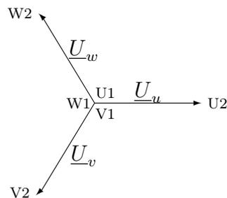
Hier passiert etwas, was bei der komplexen Rechnung nie passiert ist. Wir erkennen Nullphasenwinkel  $> 90^\circ$ . Wir müssen nun umdenken. Wir verlassen die komplexe Rechnung gänzlich. Nullphasenwinkel von  $120^\circ$  oder  $240^\circ$  entstehen durch die geometrische Anordnung unserer drei Spulen (Stränge) im Magnetfeld. Nicht etwa dadurch, dass Spule oder Kondensator an der Phase schiebt.
