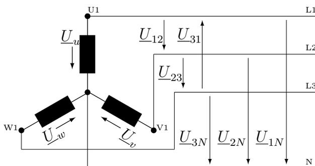
Die Strangspannungen  $\underline{U}_u$ ,  $\underline{U}_v$ ,  $\underline{U}_w$  sind gleich den Spannungen zwischen Außen- und Neutralleiter:
