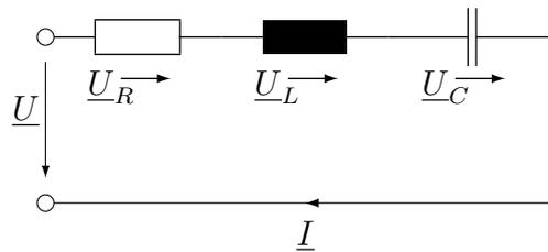
Der durch alle Bauteile fließende Strom  $\underline{I}$  wird als Bezug gewählt d.h., er wird willkürlich als realer Strom angenommen
