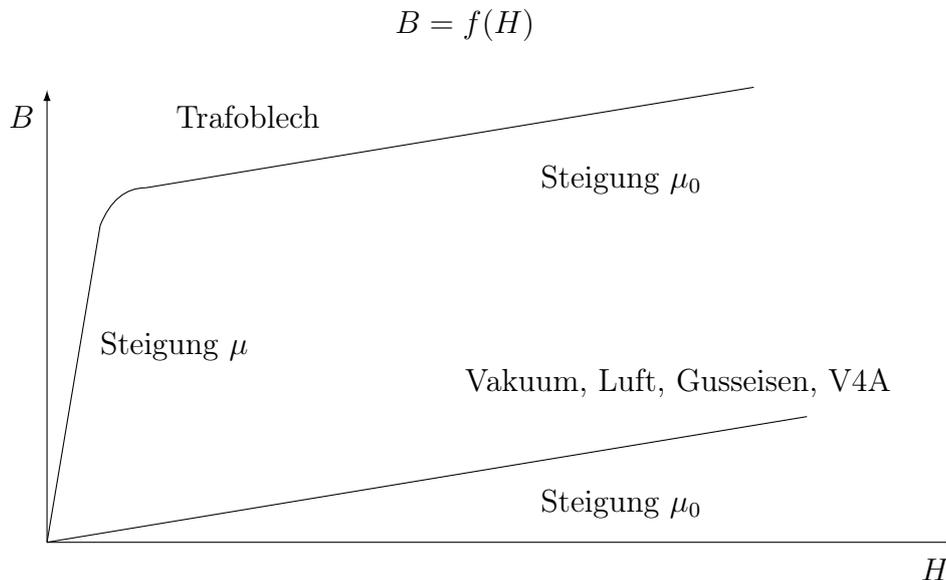
Trafoblech ist eine Eisen-Silizium-Legierung mit besonders hoher Permeabilität. Bei zunehmender Feldstärke  $H$  steigt die Flussdichte  $B$  mit großer Steigung an. Mit Erreichen der Sättigung nimmt die Steigung stark ab und ist nur noch so groß, wie bei unmagnetischen Stoffen.
