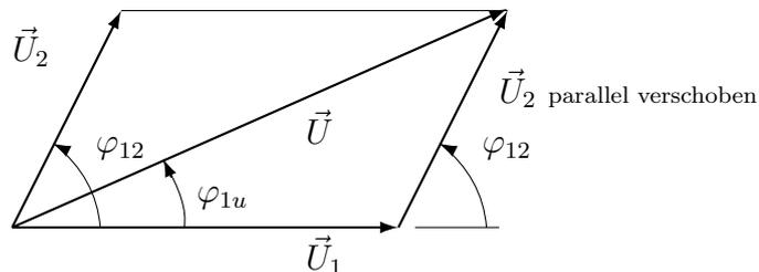
Mit zeichnerischen Mitteln ist  $\vec{U}$  und  $\varphi_{1u}$  leicht zu ermitteln. Rechnerisch muss der Kosinussatz bemüht werden.
