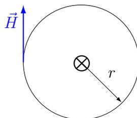
$$I = H \ell, \quad \text{Durchflutungsgesetz} \quad (15)$$
