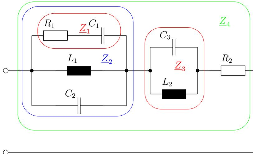
Lösung: Die Schaltung wird in Teile zerlegt, die aus reinen Parallelschaltungen bzw. reinen Reihenschaltungen besteht. Diese Teile werden als passive Zweipole betrachtet und deren komplexer Scheinwiderstand berechnet. Wir gehen von innen nach außen, von untergeordnet zu übergeordnet vor.
