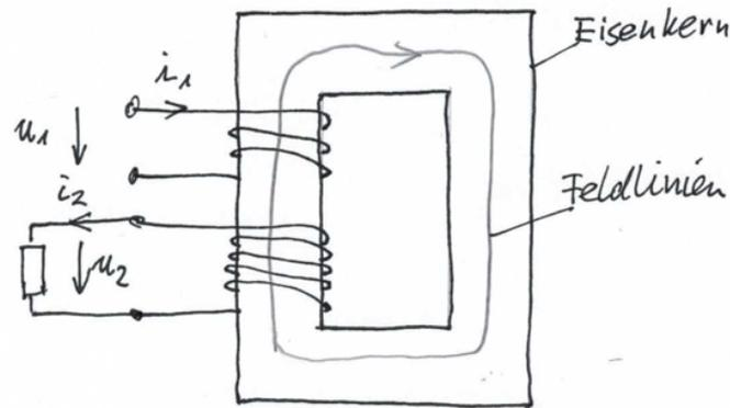
Die Spannungen  $u_1$  und  $u_2$  sind zeitveränderlich (Vorgriff: es werden sinusförmige Wechselspannungen sein). Bei einem realen Transformator würden wir natürlich eine Spule am gegenüberliegenden Schenkel anbringen. Hier können wir aber gut erkennen, dass beide Spulen den gleichen Wicklungssinn haben. Die Stromrichtungen sind allerdings wegen der Lenz'schen Regel unterschiedlich.
