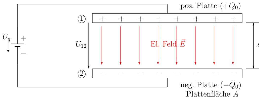
Zwischen den Kondensatorplatten aus elektrisch leitendem Material, an die eine Spannungsquelle angeschlossen ist, entsteht das elektrische Feld, beschrieben durch den Feldvektor  $\vec{E}$ . Anders als ein Kraftvektor hat ein Feldvektor keinen festen Angriffspunkt. Innerhalb eines bestimmten Raums, hier zwischen den beiden Kondensatorplatten ist die Feldwirkung überall. Die roten Pfeile sind daher nur ein Symbol dafür, dass eine Feldwirkung vorliegt.
