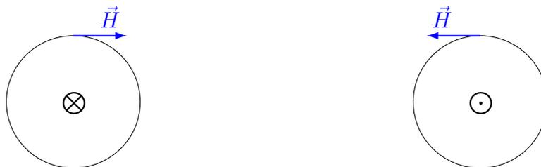
Im rechten Bild fließt der Strom aus der Zeichenebene heraus nach oben. Hier hilft die „rechte-Hand-Regel“. Der Daumen zeigt in Stromrichtung, die gekrümmten anderen Finger der rechten Hand zeigen in positive  $\vec{H}$ -Richtung.
