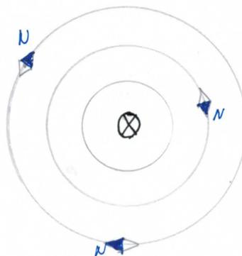
Wir haben ein konzentrisches Feld um den Leiter, es wird beschrieben durch Feldlinien. Das Magnetfeld wird beschrieben durch den Vektor der Magnetischen Feldstärke  $\vec{H}$ . Die Richtung ist immer tangential zu den Feldlinien.
